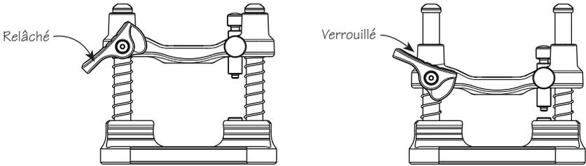
Figure 3 : Mouvement de plongée
