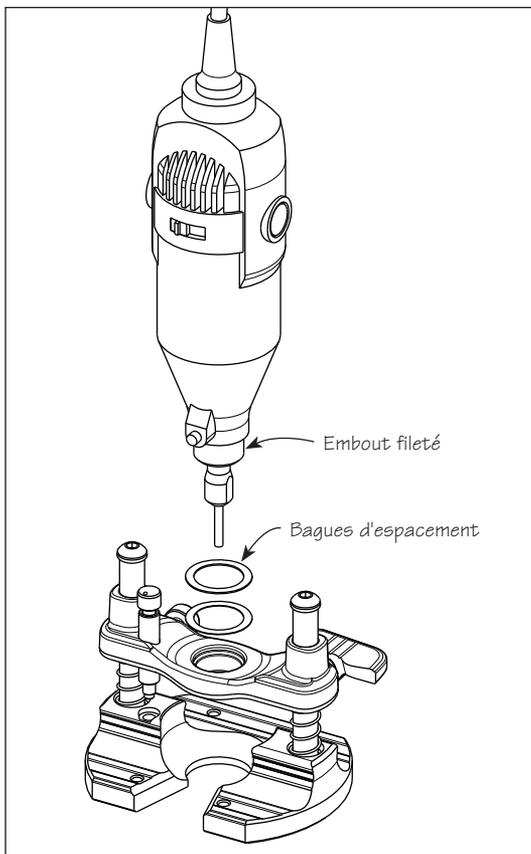
Figure 2 : Montage de l'outil sur la base
